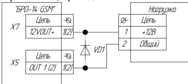
Рис.7 Подключение выходов к нагрузке при использовании выхода для питания внешних потребителей (Напряжение на нагрузке 11,0...12,0В, максимальный суммарный (для двух выходов) ток потребления 100mA. Диод VD1 нужен, если нагрузкой является катушка реле. Допустимое обратное напряжение диода должно быть не менее 20В).
