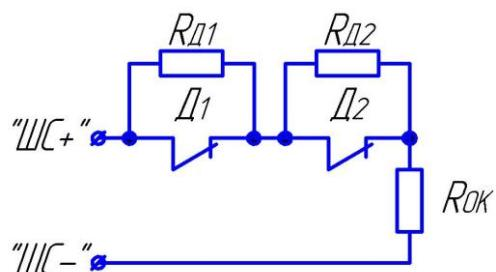
Рис.5 Схема подключения проводных пожарных тепловых датчиков к шлейфу с типом =15 (Д1, Д2 – контакты пожарных тепловых датчиков; ROK – оконечный резистор номиналом 4,3 кОм  $\pm 5\%$ ; RД1, RД2 – добавочные резисторы номиналом 6,8 кОм  $\pm 5\%$ . Максимальное допустимое сопротивление проводов шлейфа в данной схеме – 470 Ом; минимальное допустимое сопротивление утечки между проводами шлейфа – 50 кОм; максимальный допустимый ток утечки – 0,21 мА).
