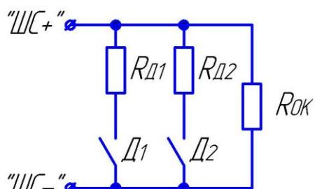
Рис.6 Схема подключения проводных пожарных дымовых датчиков к шлейфу с типом =15 (Д1, Д2 – контакты пожарных дымовых датчиков; ROK – оконечный резистор номиналом 5,6 кОм  $\pm 5\%$ ; RД1, RД2 – добавочные резисторы номиналом 2,2 кОм  $\pm 5\%$ . Максимальное допустимое сопротивление проводов шлейфа в данной схеме – 470 Ом; минимальное допустимое сопротивление утечки между проводами шлейфа – 7 кОм; максимальный допустимый ток утечки – 1,5 мА).
