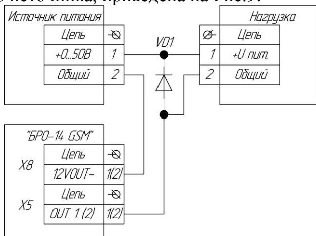
Рис.8 Подключение выходов при использовании отдельного источника питания (Напряжение на нагрузке 0...50В, максимальный ток потребления 500mA на каждый выход. Диод VD1 нужен, если нагрузкой является катушка реле. Допустимое обратное напряжение диода должно превышать напряжение источника питания).
