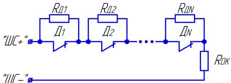
Рис.3 Схема подключения проводных пожарных тепловых датчиков к шлейфу с типом =7 (Д1...ДN – контакты пожарных тепловых датчиков; ROK – оконечный резистор номиналом 5,6 кОм  $\pm 5\%$ ; RД1, RД2 ... RDN – добавочные резисторы номиналом 5,6 кОм  $\pm 5\%$ . Максимальное допустимое сопротивление проводов шлейфа в данной схеме – 470 Ом; минимальное допустимое сопротивление утечки между проводами шлейфа – 25 кОм; максимальный допустимый ток утечки – 0,4 мА).
