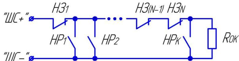
Рис.2 Схема подключения проводных охранных датчиков (H3 – нормально замкнутый контакт охранного датчика; HP – нормально разомкнутый контакт охранного датчика; Rok – оконечный резистор номиналом 4,7 кОм ±5%. Максимальное допустимое сопротивление проводов шлейфа в данной схеме – 470 Ом; минимальное допустимое сопротивление утечки между проводами шлейфа – 18 кОм; максимальный допустимый ток утечки – 0,6 мА).
