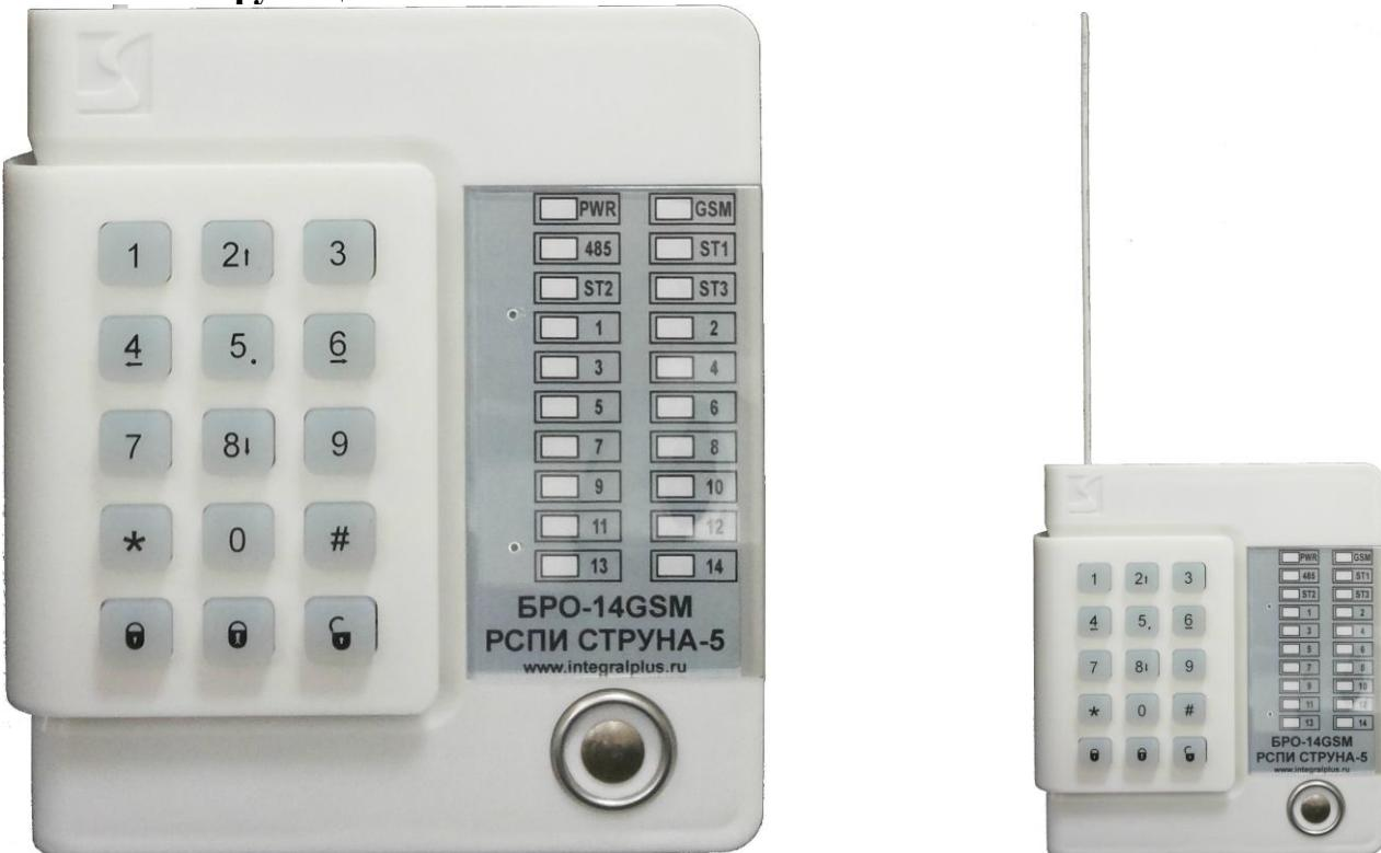
Рис.1 БРО-14GSM внешний вид (без антенны для беспроводных датчиков и с антенной).
