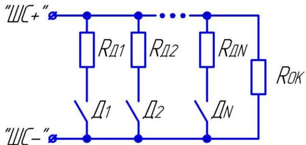
Рис.4 Схема подключения проводных пожарных дымовых датчиков к шлейфу с типом =7 (Д1...ДN – контакты пожарных дымовых датчиков; ROK – оконечный резистор номиналом 5,6 кОм  $\pm 5\%$ ; RД1, RД2 ... RДN – добавочные резисторы номиналом 2,2 кОм  $\pm 5\%$ . Максимальное допустимое сопротивление проводов шлейфа в данной схеме – 470 Ом; минимальное допустимое сопротивление утечки между проводами шлейфа – 7 кОм; максимальный допустимый ток утечки – 1,5 мА).
